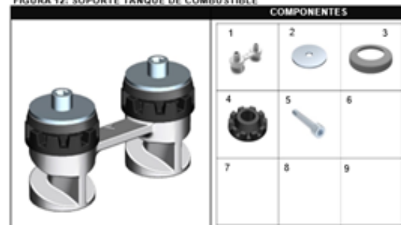
FIGURA 12: SOPORTE TANQUE DE COMBUSTIBLE
