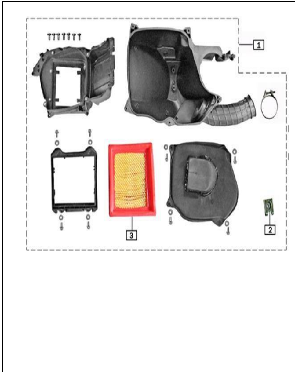
FIGURA N° 24: CAJA FILTRO AIRE
