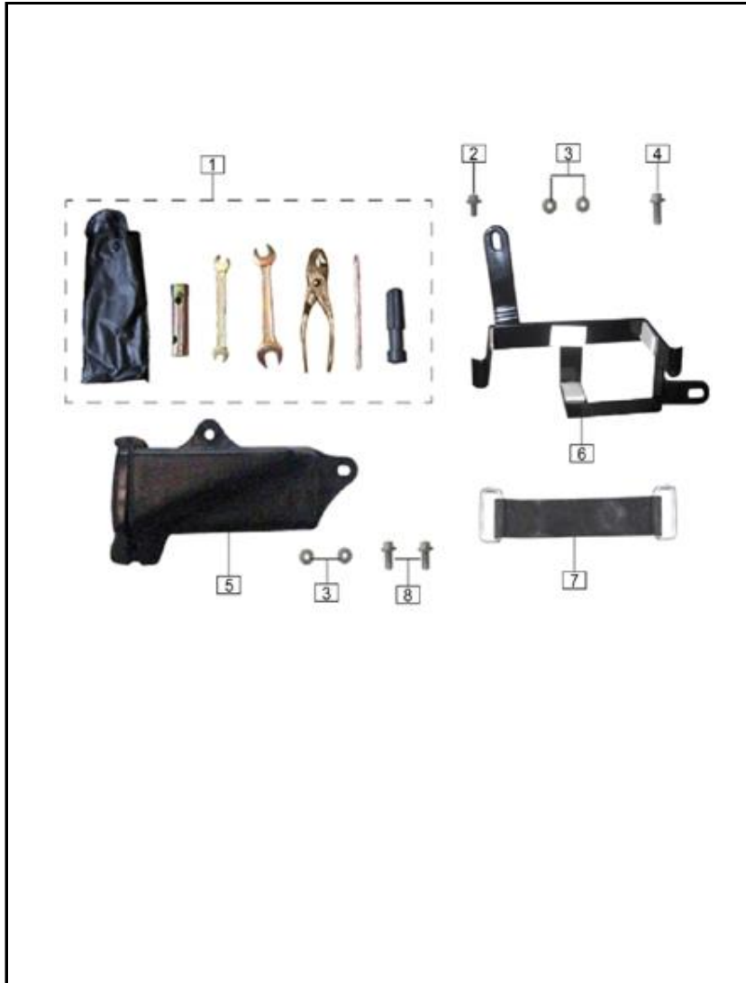
FIGURA N° 14: SOPORTE BATERIA-CAJA HERRAMIENTAS
