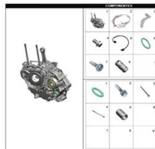
FIGURA N° 111: CARCA SA IZQUIERDA
